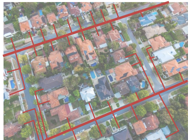
Erschliessung über Stammkabel und Muffen
